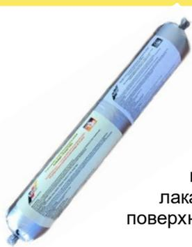
Однокомпонентный экологически чистый акриловый герметик, разработанный специально для деревянного домостроения. После высыхания, образует дышащий (паропроницаемый) шов, с высокой эластичностью и устойчивостью к УФ облучению, выдерживающий перепады температур. Имеет отличную совместимость со многими лаками, красками, пропитками при окрашивании. Возможно применение по минеральным поверхностям (бетону, штукатурке, кирпичу), ПВХ, металлу, оцинковке и др.
